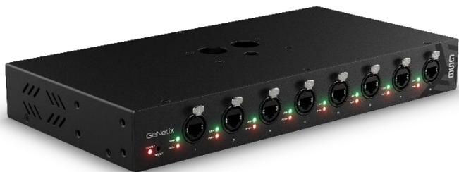
GeNetix Switch 8 は 8 ポートのアンマネージドギガビット PoE ネットワークスイッチで、8 ポート合計で最大 200W の PoE 出力を提供します。
